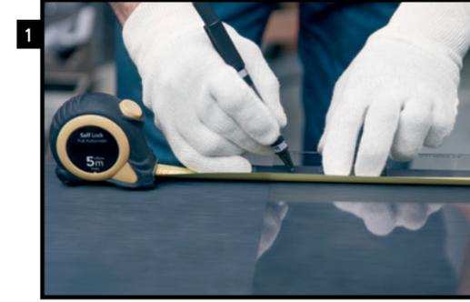
1 Corte el Artglass 99™ por la cara no recubierta.
