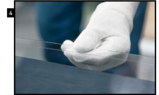
4 Para el uso de un cortador de vidrio manual, coloque la parte recubierta con el filtro ultravioleta sobre una base limpia, antideslizante y no abrasiva para evitar arañazos en la superficie.
