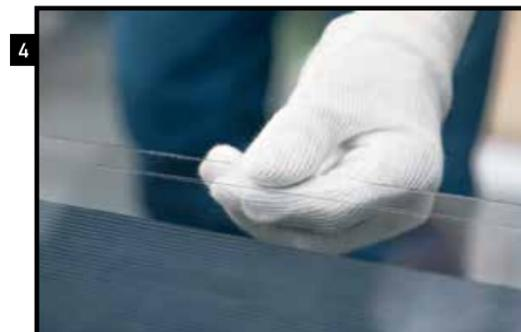
4 Se si utilizza un tagliavetro manuale, collocare il lato munito di rivestimento UV su una superficie antiscivolo pulita e non abrasiva, per evitare che si formino graffi sul vetro.
