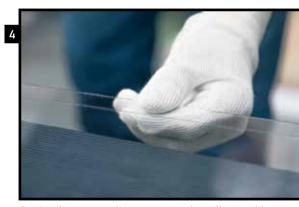
Se si utilizza un tagliavetro manuale, collocare il lato munito di rivestimento UV su una superficie antiscivolo pulita e non abrasiva, per evitare che si formino graffi sul vetro.
