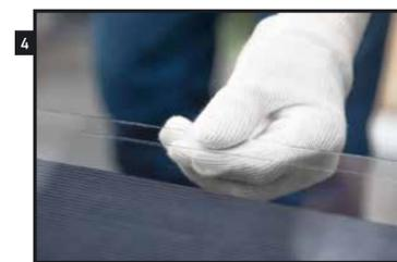
4 При использовании ручного стеклореза положите сторону с УФ-блокирующим покрытием на чистую, нескользкую, неабразивную поверхность, чтобы избежать появления царапин на поверхности.
