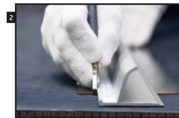
2 Любой стеклорез, который вы используете для резки стекла без покрытия, подходит для резки Artglass 99™ и Artglass AR 99™.
